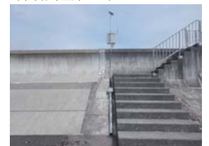
危機管理型水位計設置例 (木曾川左岸4.8k)
