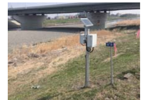
危機管理型水位計設置例 (木曾川左岸4.8k)
